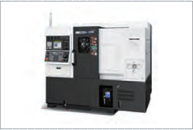
CNC Lathe (8") : 2EA Maker : WIA Size : \Phi 350 x 270
