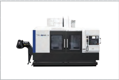
Machining Center (Vx 650) : 2EA Maker : WIA Size : 1400 x 660 x 635
