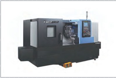
CNC Lathe PUMA GT2100M : 1EA Maker : DOOSAN Size : \Phi 300 x 513
